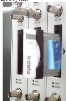
Рис.3. САМ-модуль Irdefto с картой доступа САМ-модуль в ресивере
