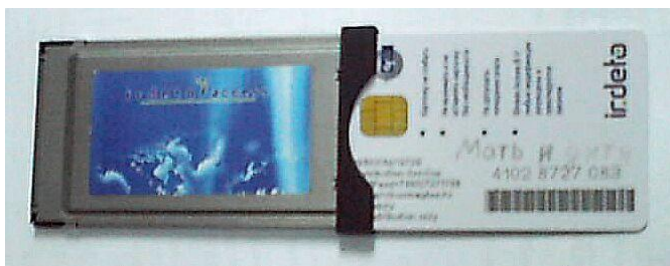
Рис.3. САМ-модуль Irdefto с картой доступа САМ-модуль в ресивере
